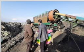
دستگاه پردازش با ظرفیت ۵۰ تن در روز
