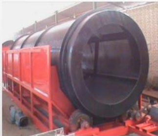
دستگاه پردازش با ظرفیت ۵۰ تن در روز
