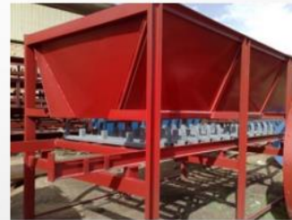
فیدر تغذیه یا سکوی مواد جهت انتقال به مرحله دانه بندی
